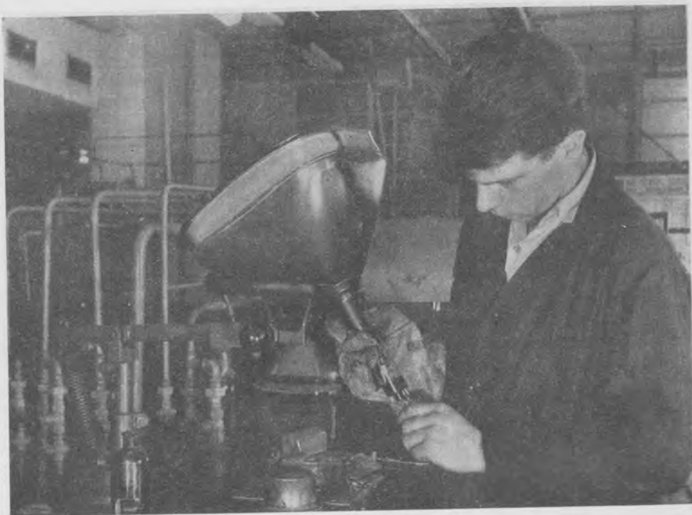
Obr. 132. Tmelení patice obrazovky.
