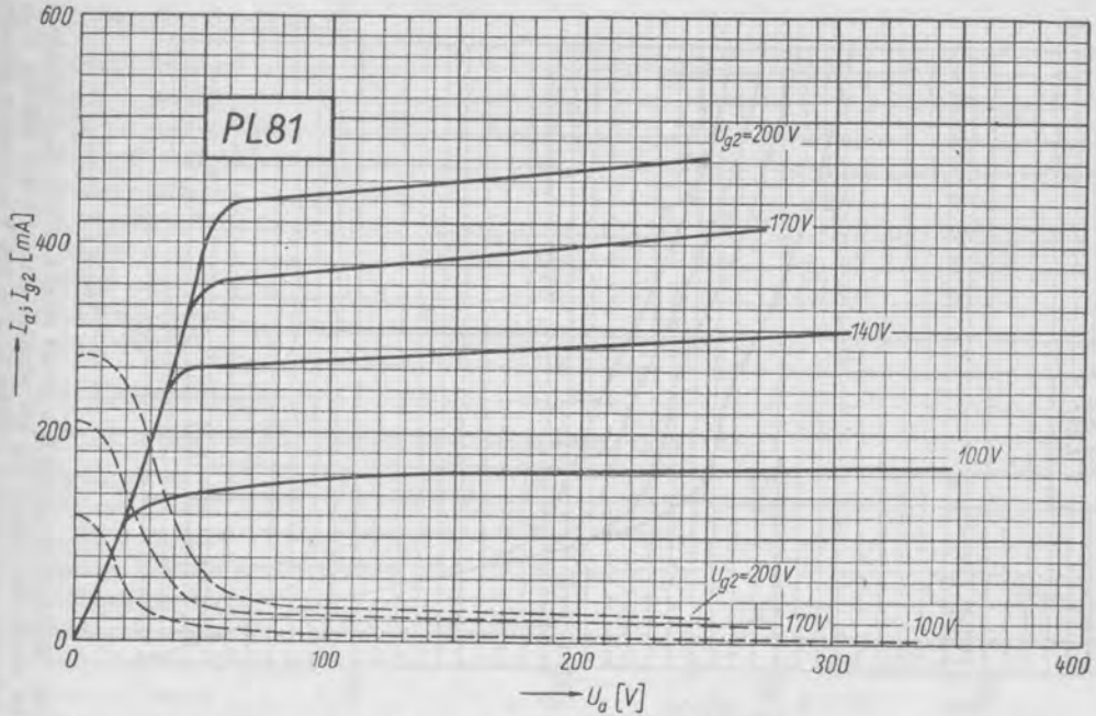
Dg. 67. Anodový proud I_a a proud stínící mřížky I_{g2} v závislosti na anodovém napětí U_a při různém napětí stínící mřížky U_{g2} . Napětí řídicí mřížky U_{g1} = -1 V.
