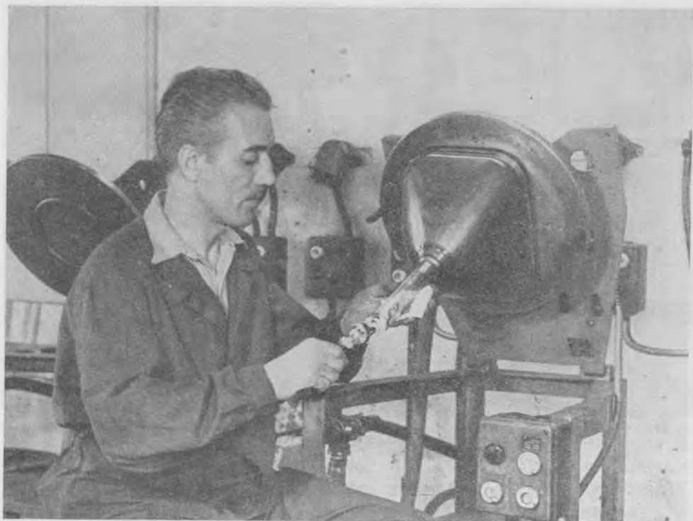
Obr. 107. Úprava vnitřního povrchu baňky obrazovky po grafitování.
