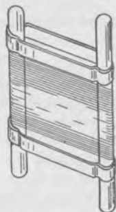
Obr. 3. Příklad provedení rámečkové mřížky.
